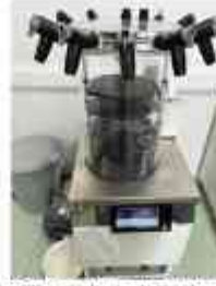
Lyofilizatör cihazında dondurarak kuruma işlemi ile sıvıya uzaklaştırılması
